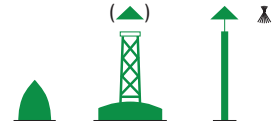
Steuerbordseite Fahrwasser (von See kommend)
